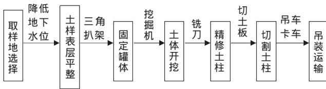
图3 原状土取样流程
