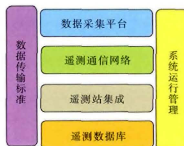
图 1 水文自动测报系统集成与整合总体设计框架
