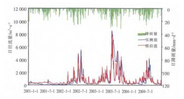
图 4 研究区流域率定期(2001~2004年) 日降雨、径流模拟与实测结果比较
