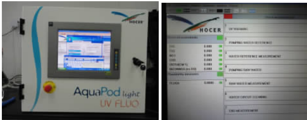
图1 AQUAPOD light 分析仪及其软件界面
