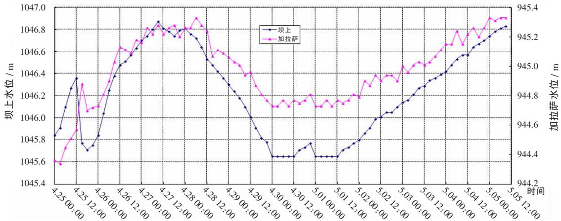
图2 堰塞湖上下游水位比较图
