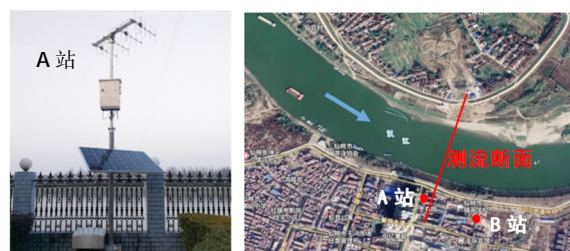
图1 仙桃站 UHF 雷达测流系统布设位置
